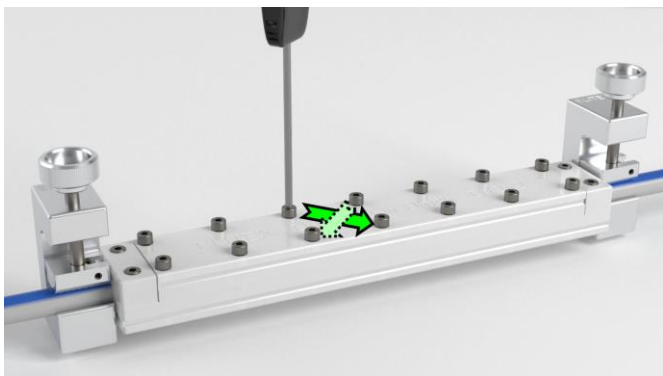
2.7.5 Oberschale aufsetzen und Schrauben mit 3 mm Innensechskant Schlüssel von der Mitte aus über Kreuz befestigen. Anzugsmoment >5 Nm.
