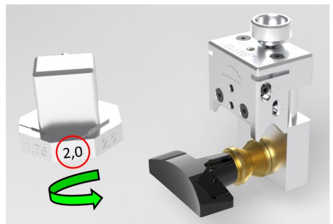
2.1.9 Am Schnitttiefeinsteller die entsprechende Wandstärke des Mikrorohrs durch drehen der Wahlscheibe einstellen z.B. 2,0 mm.
